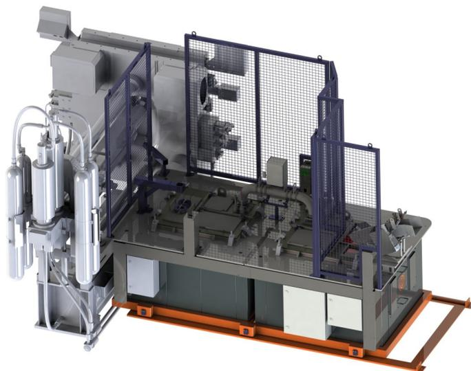
Zweikammer Schmelzanlage mit einer
