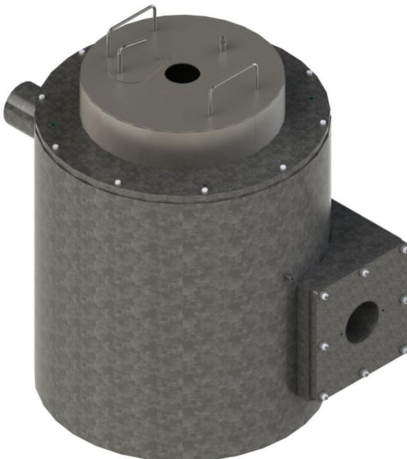
Tiegelschmelzofen für 110kg flüssiges
