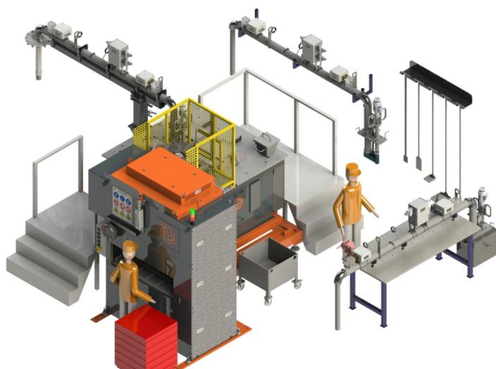
Einkammer Schmelzanlage mit einer
